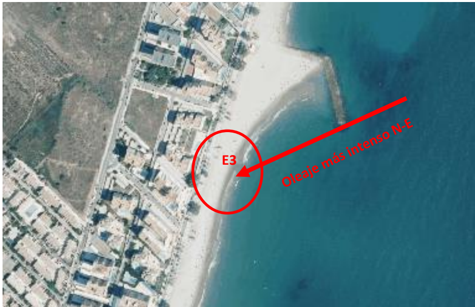
Figura 43. Incidencia de las olas sobre el punto E3, que es donde la playa seca es actualmente más estrecha y donde el perfil sumergido presenta mayor pendiente. Las olas más enérgicas, de dirección N-E, se canalizan en la zona, donde el espigón ya no protege, incidiendo sobre esta zona con toda su intensidad.
